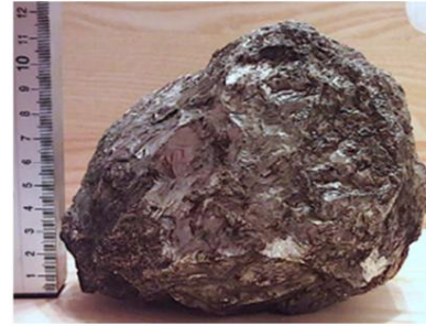
Abbildung 9. Der 8 kg schwere Eisensilicidbrocken aus dem Streufeld des Chiemgau-Impakts.
