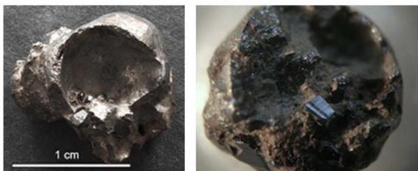
Abbildung 8. Eisensilicidpartikel mit angelagerten Mineralkristallen (oben) Unten: Eisensilicid mit angelagerten mikrosphärolithischen Partikeln. Probengröße 8 mm.
