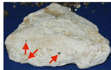
Abbildung 10. Oben: Das sogenannte Kombi-Material der frühen Untersuchungen mit FESI-Plättchen und -Kügelchen. Unten: Ein Kalksteinblock mit Einschlüssen winziger FESI-Partikel (Pfeile).
